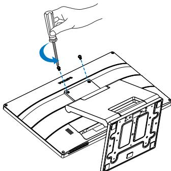
2. Перемістіть підставку в положення, показане на малюнку. Потім за допомогою викрутки відкрутіть гвинти та від'єднайте підставку від монітора.
