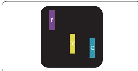
Dve sosednji osvetljeni pod-slikovni točki:
