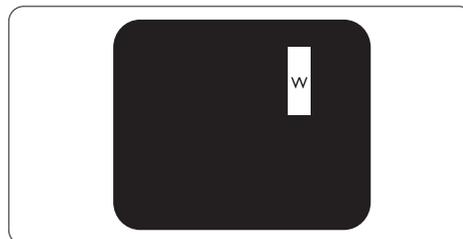
Tri sosednje osvetljene pod-slikovne točke (bela slikovna točka)
