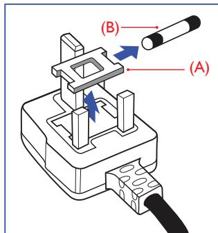
本装置配有一个经过认可的 13A 模制插头。如要更换这种插头中的保险丝，请按如下步骤操作：
