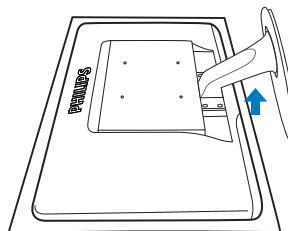
2. Нажмите фиксирующие зажимы, чтобы отсоединить подставку монитора от стойки основания.
