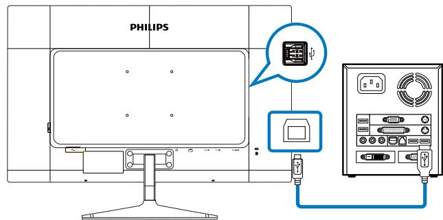
1. Conectați cablul USB de la PC la portul ascendent al hubului USB de pe modulul I/O lateral al monitorului.
