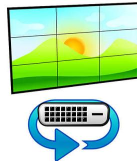
Bauen Sie mit einer DVI-Reihenschaltung eine digitale Videowand aus bis zu 150 Bildschirmen in einer 15 x 10-Konfiguration. Verbinden Sie einfach den DVI-Ausgang mit einem DVI-Eingang an einem anderen Bildschirm. Damit erlangen Sie das beeindruckendste Videowanderlebnis, das es gibt.
