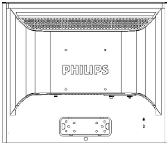
**Obs:** Till denna monitor passar en 100 mm x 100 mm VESA-kompatibel monteringsatts.
