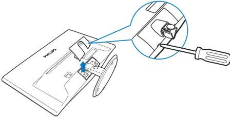
2. Lösen Sie die vier Schrauben, nehmen Sie die Basis anschließend vom Monitor ab.
