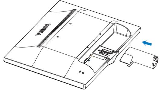
3. Uchopte monitor oběma rukama a připevněte stojánek podstavce do sloupku podstavce.
