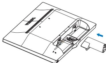
3. Tenere la base del monitor con entrambe le mani ed inserire con fermezza la base nel supporto.
