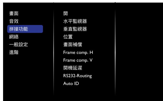
本功能可建立一個大型螢幕矩陣（電視牆），最多可由 100 部顯示器組成（垂直最多 10 部且水平最多 10 部）。
