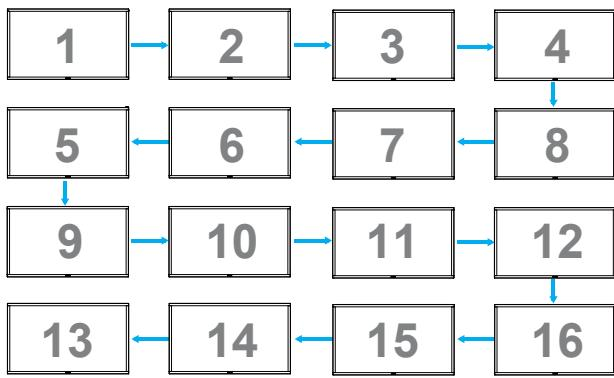
註：若要使用此功能，請用 RS-232 纜線串聯所有機器並將網路控制連接埠設為 RS-232。
