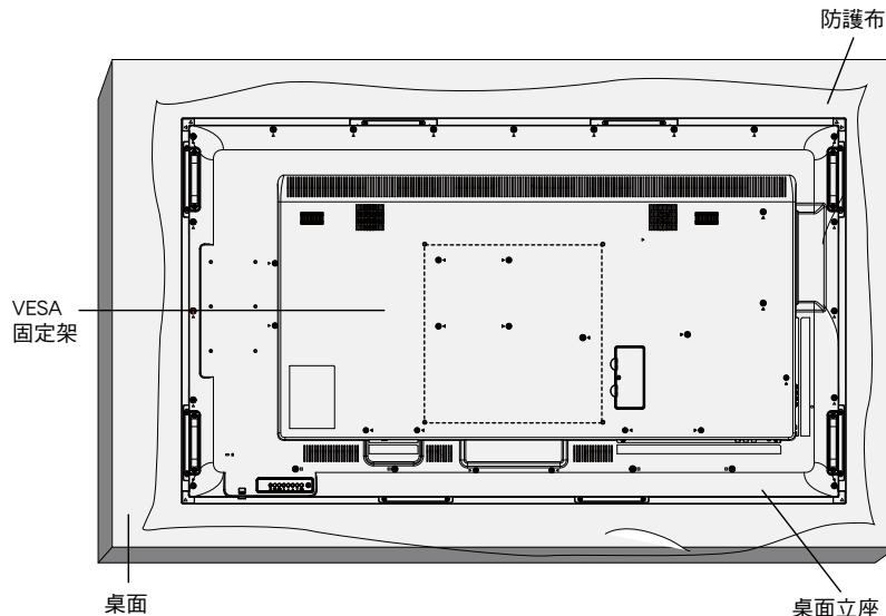
1. 將包裝時包覆顯示器的防護布鋪在桌面上，將螢幕朝下擺放防護布上，以免刮傷螢幕表面。
