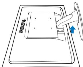
2. 將固定卡榫往下壓，然後將底座支架從底座上拆下。
