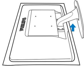
2. 請用雙手抓住顯示器底座支架，並將底座支架確實裝入底座安裝座中。
