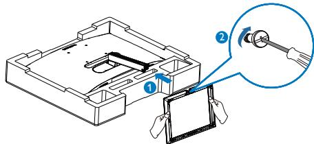
3. ベースを取り付けたら、両手でモニターと発泡スチロールと一緒にしっかりと保持して立てます。発泡スチロールを引き出してください。このモニターは湾曲したデザインであることに注意してください。発泡スチロールを引き出すときは、パネルの破損を避けるため、パネルを絞らないでください。
