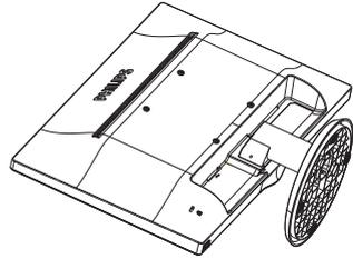
2. 壓下鎖定夾可分離底座支架與底座安裝座。
