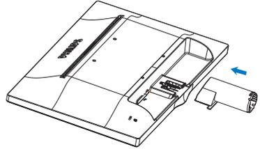
3. 請用雙手緊握顯示器底座支架，並將底座支架確實裝入底座安裝座中。
