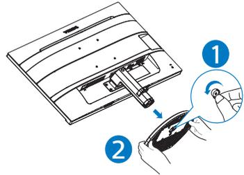
3. 使用螺丝刀卸下支撑臂上的螺丝，然后从显示器分离支撑臂/支架。
