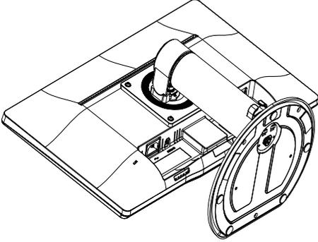
2. 使用平頭螺絲起子將絞鏈蓋上的四處薄膜移除。
