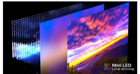
Mini LED pozadinsko osvetljenje unapređuje kontrolu osvetljenja i odnos kontrasta. Mala veličina mini LED dioda koje čine pozadinsko osvetljenje omogućava kreiranje 1152 zone sa pojedinačnom kontrolom, čime se dobija dublja crna i svetlija bela. Bogati HDR sadržaj sada možete da gledate onako kako je predviđeno, uz neprikosnoven kontrast i preciznu reprodukciju.
