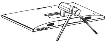
2. Remova a tampa da dobradiça do corpo do monitor utilizando uma ferramenta auxiliar.
