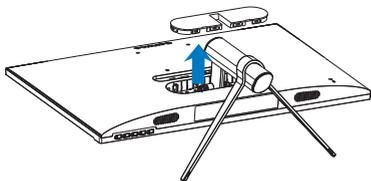
3. Utilize uma chave de fendas para remover os parafusos da coluna e desencaixe a coluna/suporte do monitor.
