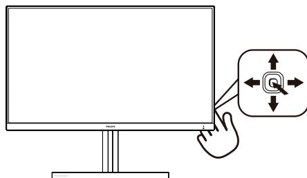
此Philips显示器的OSD菜单可以通过显示器面板背面的单触按钮来访问。单触按钮的操作类似于操纵杆。向四个方向按下按钮可以移动光标。向里按下按钮可以选择所需的选项。
