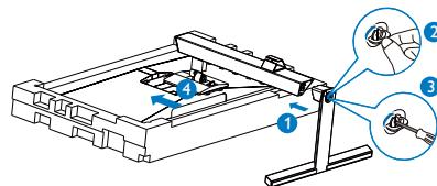
3. 安装底座后，用双手抓住与塑料泡沫紧扣在一起的显示器，使显示器直立。现在可以拔出泡沫塑料了。拔出泡沫塑料时，不要挤压面板以避免损坏面板
