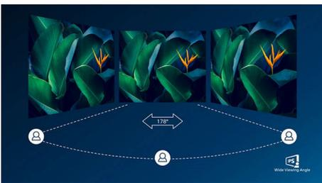
IPS-Monitore verwenden eine fortschrittliche Technologie, die für einen besonders großen Blickwinkel von 178/178 Grad sorgt und es so ermöglicht, Inhalte auf dem Monitor aus nahezu jedem Winkel zu sehen – selbst im 90-Grad-Schwenkmodus! Im Gegensatz zur standardmäßigen TN-Technologie erhalten Sie
