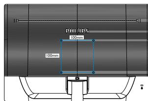
2. Нажмите фиксаторы, чтобы отсоединить подставку монитора от основания.
