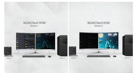
内蔵 KVM は 1 組のキーボードとマウスで 2 台のデバイスの制御と切り替えを可能にし、MultiView は両ソースの 1 画面同時表示を可能にします。これらの機能により、煩雑になりがちなケーブル問題を解消し、貴重な時間を節約することができます。PC を 2 台使用するストリーマーやコンテンツクリエイター、LAN イベント用にデバイスを準備する際に最適です。
