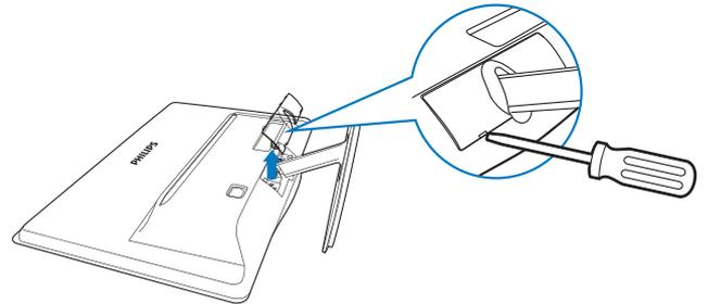
2. Retire los 4 tornillos y, a continuación, la base del monitor.
