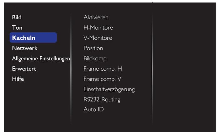
Mit dieser Funktion können Sie eine einzelne große Bildschirmmatrix (Videowand) erstellen, die aus bis zu 100 Anzeigegeräten besteht (**bis zu 10 Geräte je Spalte/Zeile**).
