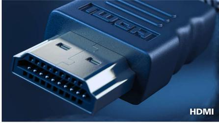
Naprava s podporo za HDMI ima vso potrebno strojno opremo za sprejem signalov prek vmesnika HDMI (High-Definition Multimedia Interface). Kabel HDMI omogoča prenos visokokakovostnih digitalnih video in zvočnih signalov prek enega kabla iz računalnika ali več AV-virov (tudi digitalnih sprejemnikov, DVD-predvajalnikov, A/V-sprejemnikov in videokamer).
