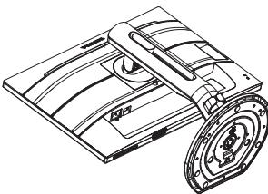
3. Нажав кнопку фиксатора, наклоните основание и извлеките его.
