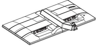
2. Cu ajutorul degetelor, strângeți șurubul localizat în partea inferioară a bazei și fixați ferm baza pe suport.
