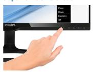
SmartTouch — это интеллектуальные сенсорные кнопки, заменившие обычные выступающие кнопки. Восприимчивые к самым легким прикосновениям, кнопки SmartTouch могут управлять включением монитора или яркостью и резкостью дисплея с функцией SmartImage Lite. Во время работы значки SmartTouch светятся, чтобы показать, что команда была выполнена.
