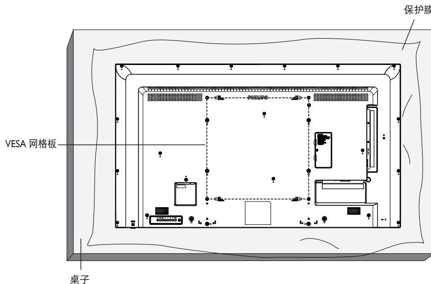
1. 将保护膜（打包时包裹在显示器上）铺在桌子上，将显示器正面朝下放在保护膜上，以免刮擦屏幕表面。
