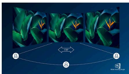
В дисплеях IPS используется прогрессивная технология, обеспечивающая широкий угол обзора 178/178 градусов для просмотра практически под любым углом. По сравнению со стандартными TN-панелями, дисплеи IPS обеспечивают значительно более высокую четкость изображения и яркие цвета, что делает их идеальным решением не только для просмотра фотографий, фильмов и веб-сайтов, но также и для работы в профессиональных приложениях, где требуется точная передача цвета и яркости.
