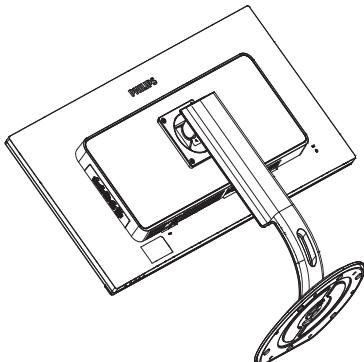
2. Uvoľnite montážne skrutky a potom z monitora odpojte čap.
