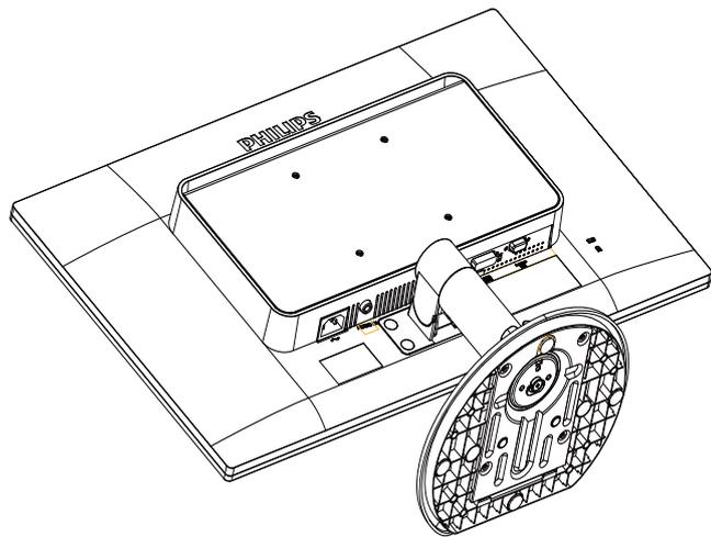
2. Utilisez un tournevis plat pour enlever les quatre vis mylar du bord du couvercle.
