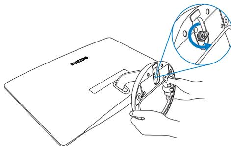
2. Entfernen Sie die Schraube vom Standfuß und ziehen Sie die Unterseite anschließend vom Monitor ab.
