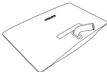
2. Bringen Sie den Monitorstandfuß an der Stütze an und befestigen Sie anschließend den Standfuß.
