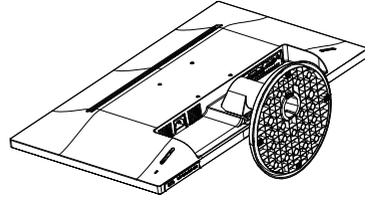
2. 将显示器底座支撑柱装到定位，直至其卡入位置。
