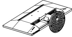
2. 按锁定夹，从底座支撑柱上卸下底座支撑臂。
