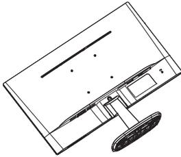
1. 固定クリップを押して、ベーススタンドをベース支柱から取り外します。
