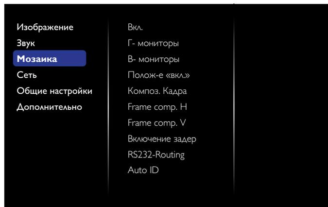
С помощью данной функции можно создавать единый большой экран (видеоэкран), включающий до 100 мониторов (**до 10 мониторов по вертикали и 10 мониторов по горизонтали**).
