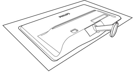
2. Tenez le support du socle avec deux mains et insérez fermement le support du socle dans la colonne du socle.
