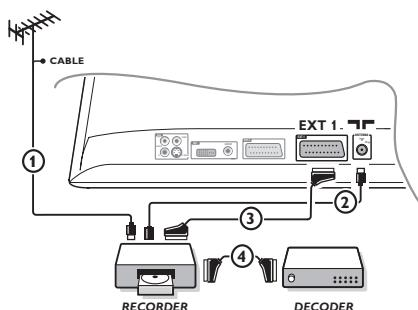
Κάνετε τις συνδέσεις που φαίνονται στο διπλανό σχέδιο χρησιμοποιώντας ένα καλώδιο ευρωσυνδετήρα καλής ποιότητας.
