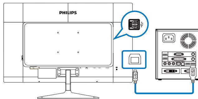
1. Connectez votre câble USB en amont du concentrateur USB sur le côté IO du moniteur du côté PC.
