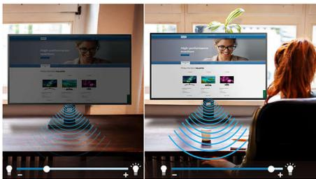
PowerSensor ist ein integrierter Sensor, der durch das Aussenden und Empfangen unbedenklicher Infrarotsignale erkennt, ob sich der Benutzer in der Nähe des Geräts aufhält, und automatisch die Bildschirmhelligkeit reduziert, wenn der Benutzer sich vom Schreibtisch entfernt. So wird der Energieverbrauch um bis zu 70 % gesenkt und die Monitorlebensdauer verlängert.
