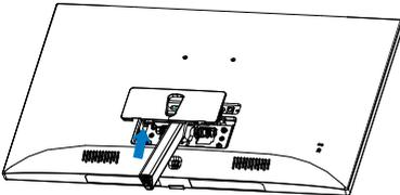
4. Викрутіть гвинти з тримача за допомогою викрутки та від'єднайте тримач/підставку від монітора.
