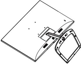
2. Відкрутіть гвинт унизу основи за допомогою пальців і від'єднайте основу від підставки.
