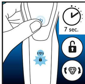
Después de reemplazar los cabezales de afeitado, puedes restablecer el recordatorio de reemplazo si presionas el botón de encendido/apagado durante más de 7 segundos. De lo contrario, el recordatorio de reemplazo se desactivará automáticamente después de 9 afeitados sucesivos.
