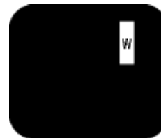
Tres subpíxeles adyacentes iluminados (un píxel blanco)
