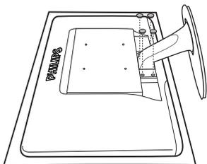
2. Lösen Sie die 4 Schrauben, nehmen Sie die Basis anschließend vom Monitor ab.
