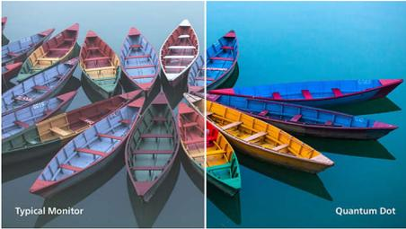
La tecnologia Quantum Dot è un'innovativa tecnologia ai nanocristalli semiconduttori in grado di emettere luce in maniera estremamente precisa, per produrre blu più blu, verdi più verdi e rossi più rossi. I monitor LCD dotati di Quantum Dot producono una gamma di colori più dinamica e visualizzano immagini con tonalità davvero naturali. Il risultato è costituito da colori intensi e dinamici. Vedere per credere.
