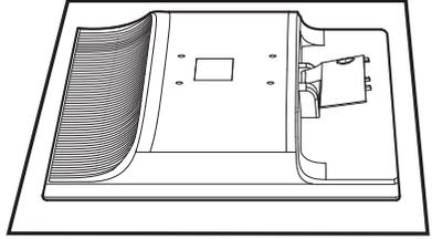
2. 用双手握住显示器底座支撑臂，用力将底座支撑臂插入底座支撑柱。
