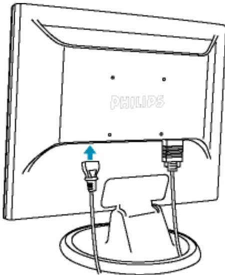
1) Stecken Sie die Kabel in die Anschlussstellen
