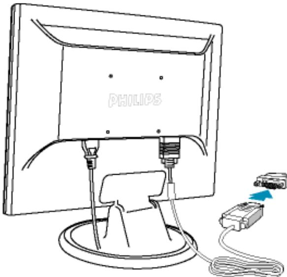
**Hinweis:** Wenn Sie einen Apple Macintosh verwenden, muss der spezielle Mac-Adapter an einem Ende des Monitor-Signalkabels angebracht werden.
