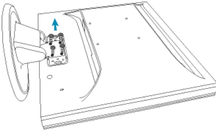
**2)** Die 4 Schrauben herausdrehen und dann den Fuß vom LCD-Monitor abnehmen.
