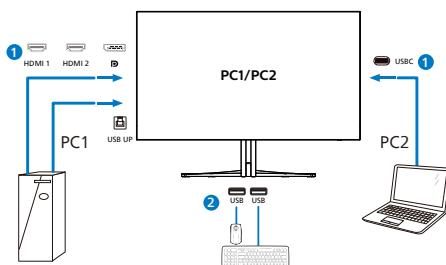
3. Otvorite meni prikaza na ekranu. Idite u KVM sloj i izaberite „Auto“, „USB C“ ili „USB Up“ za prebacivanje kontrola perifernih uređaja s jednog uređaja na drugi. Samo ponovite ovaj korak za prebacivanje kontrola sistema koristeći jedan set perifernih uređaja.
