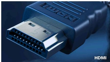
Устройство HDMI Ready обладает всем необходимым аппаратным обеспечением для работы через мультимедийный интерфейс высокой четкости (HDMI). С помощью одного HDMI-кабеля цифровой видео- и аудиоконтент высокого качества передается с ПК или с любого количества аудио- и видеоисточников (включая телеприставки, проигрыватели DVD, ресиверы A/B и видеокамеры).
