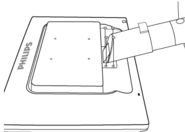
(b) Die 4 Schrauben herausdrehen und dann den Fuß vom LCD-Monitor abnehmen
